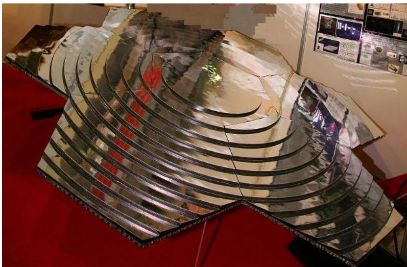
Fig. 2 TUS detector mirror-concentrator.
